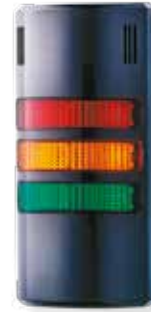
Référence: HD90-Q71 Couleurs: rouge-orange-vert Fonction: Feu LED fixe Couleur du boîtier: noir Tension nominale: 230-240 V AC
