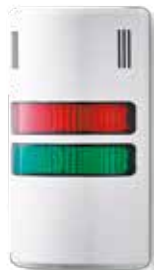
Référence: HD90-Q32 Couleurs: rouge-vert Fonction: Feu LED fixe, son pulsatoire ou permanent Couleur du boîtier: gris Tension nominale: 24 V AC/DC
