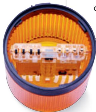
En varios módulos individuales hacen falta una gran cantidad de contactos diferentes. El nuevo sistema de contactos interno tiene 8 contactos, que permiten un total de 7 posiciones. Esto permite configurar complejas variantes de columnas ópticas/acústicas. Además, el sistema de contactos interno especial patentado mejora considerablemente el aspecto de la columna de señalización PC7, porque se han suprimido el cableado visible de los contactos que se venía utilizando hasta el momento.
