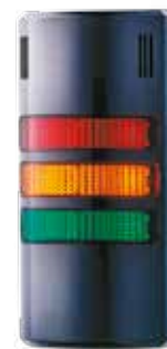
Numero articolo: HD90-Q951 Colori: rosso-arancione-verde Funzione: Faro LED statico, cicalino o suono pulsante Colore dell'involucro: nero Tensione nominale: 24 V AC/DC
