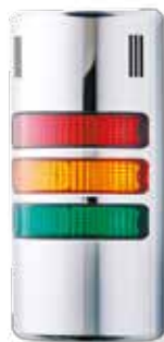
Numero articolo: HD90-Q41 Colori: rosso-arancione-verde Funzione: Faro LED statico, cicalino o suono pulsante Colore dell'involucro: cromo Tensione nominale: 24 V AC/DC
