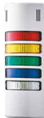
Numero articolo: HD90-Q1036 Colori: rosso-giallo-verde-blu-chiaro Funzione: Faro LED statico, cicalino o suono pulsante Colore dell'involucro: grigio Tensione nominale: 24 V AC/DC
