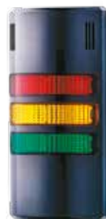
Numero articolo: HD90-Q27 Colori: rosso-giallo-verde Funzione: Faro LED Statico Colore dell'involucro: nero Tensione nominale: 24 V AC/DC
